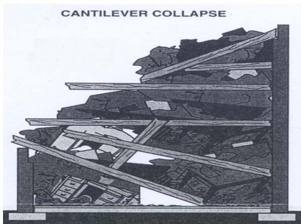
این آوار معمولاً در اثر تخریب ساختمان‌های چند طبقه بوجود می‌آید. پیداکردن مصدومین در این نوع آوار بسیار مشکل بوده و دسترسی به افراد گرفتار در زیر آن زمان بر است. مصدومین یا در جان پناه‌های ناشی از اثنایه و یا در داخل نخاله‌ها پیدا می‌شوند. خطر ریزش مجدد آوار بالا است. برای عملیات نجات، نفوذ از داخل منفذ و مجاری طبیعی ساختمان یا زیرزمین امکان‌پذیر است.
